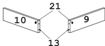
2. Вставьте эксцентрики 21 в отверстия на деталях 9, 10 стрелками к торцевым отверстиям.
