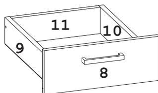
5. Соедините деталь 8 с деталями 9, 10 и затяните эксцентрики по часовой стрелке до упора.
