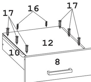
6. Вставьте деталь 12 в паз на детали 8 и выровняйте относительно деталей 9, 10 и 11.
