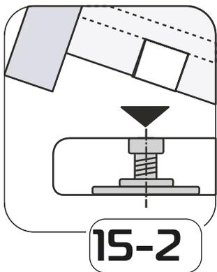
При желании, закрепите ящик к направляющим дополнительным саморезом 3x16, в комплектацию саморез не входит.
