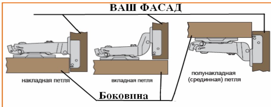
Рис. 4 Отличие петель накладных, вкладных и полунакладных
